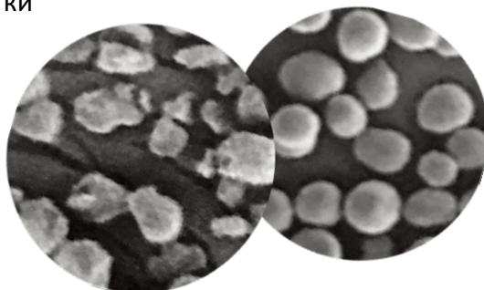
**Химически изготовленный тонер**
